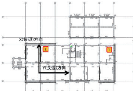
図 1.2 地盤及び建築物内部での加速度計配置
