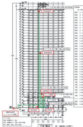
図 1.2 地盤及び建築物内部での加速度計配置
