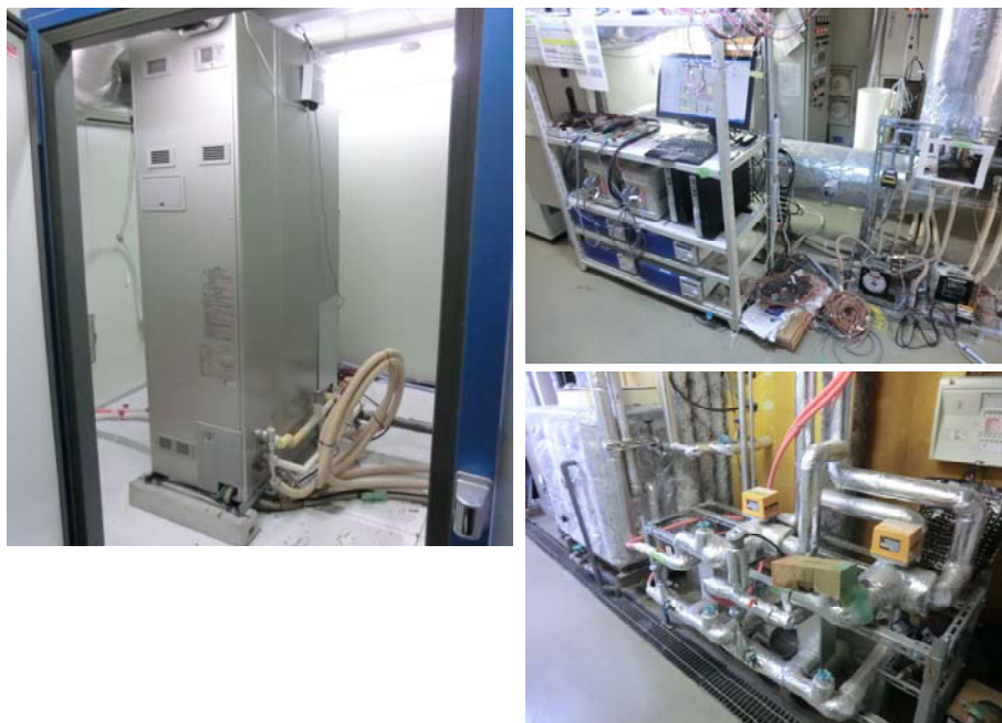
図 3.3.100 試験対象の燃料電池コージェネレーション装置と計測制御装置
