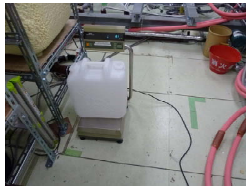
図 3.3.95 電力計測と給水流量センサーの校正
