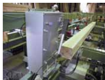
グレーディングマシンによる強度測定
