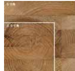
3.5寸角に比べ約2倍 の断面積の柱
