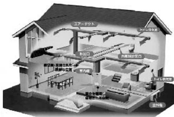
図5 セントラル暖冷房の例
