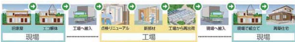
図-1 工場における大規模改修の流れ
