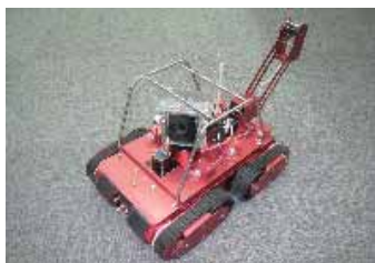
床下点検ロボット ※写真は試作機
