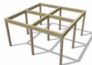
5寸柱によるメインフレーム
