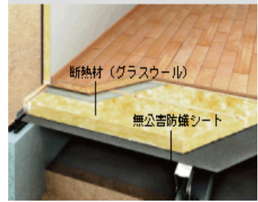
図3 無公害防蟻工法
