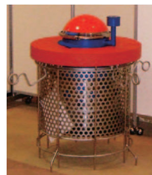
図-3.7.2 投下型水位観測ブイの外観
