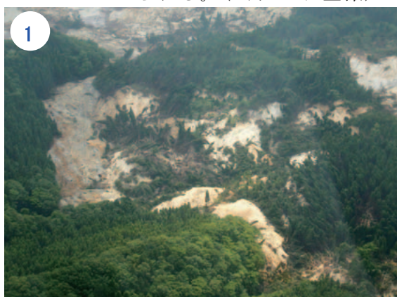
写真-3.4.4 圧縮部の近接。杉が様々な方向に倒れており土塊が乱れている。(6月15日空撮)
