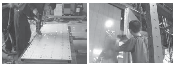
スポット溶接接合組立 角波コア型挟み込み断面パネルの2丁合わせ現場接着接合 写真2 製作風景
