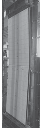
写真 6 座屈後変形 (D3c)
