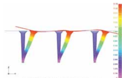
図16 水平荷重に対する変形（柱脚剛接合）
