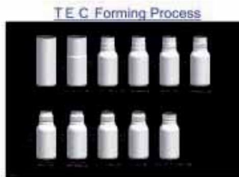
図3 リシール缶の成形プロセス
