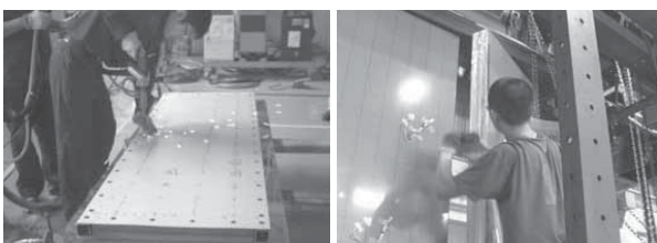
スポット溶接接合組立 角波コア型挟み込み断面パネルの2丁合わせ現場接着接合製作風景
