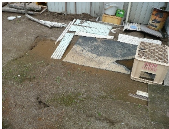
写真-4.2.27 写真-4.2.23 の敷地の噴砂痕
