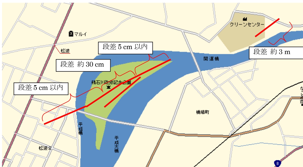
図-4.2.3 柏崎市松波～橋場町で確認した地割れの位置
