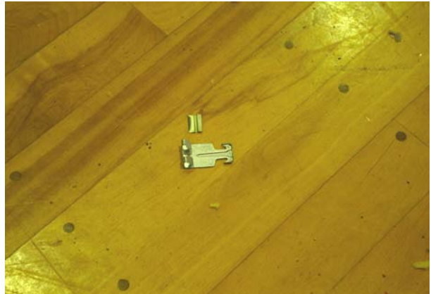
写真-7.9 落下したシングルクリップ
