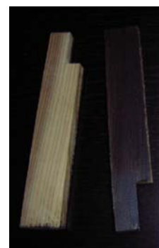
写真-4.160 落下した込み栓
