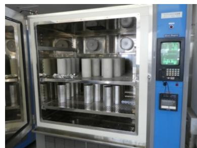
写真 1 コンクリート供試体の加熱状況
