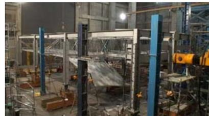
図 1 連鎖脱落する天井試験体の様子
