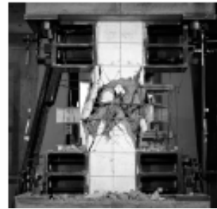
図 3 鋼材圧着による柱の破壊制御実験例
