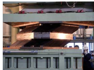
図 5 二層式 LRB の開発に関する実験例
