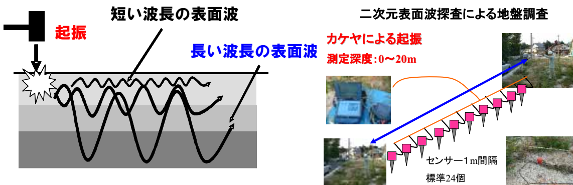
図-8.4 表面波探査の測定原理
