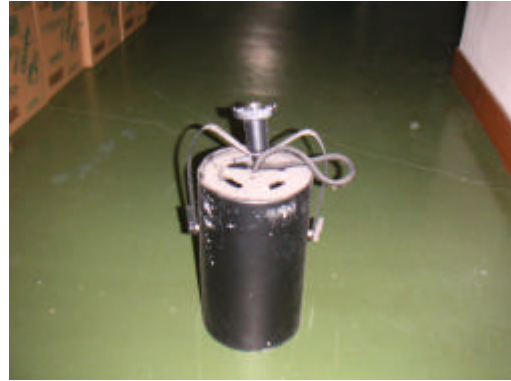
写真 7.66 落下したステージの照明 (OJY-26)
