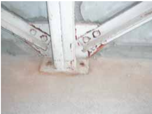
写真 7.17 ブレース付間柱脚部の破壊(HRH-4) 写真 7.18 ブレース付間柱脚部の破壊(HRH-7)
