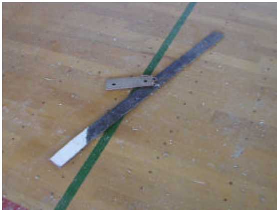
写真 7.67 落下物 鉄板 (TOK-1)
