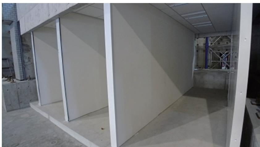
写真 5.5 試験体内部 (間仕切壁・天井)
