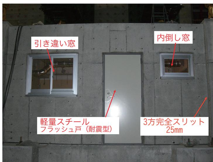
写真 5.4 試験体西面外壁
